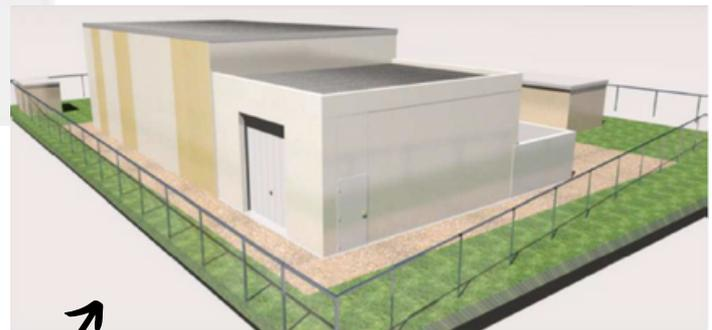
Remplacement par une cuve au sol d'une contenance de 620 m<sup>3</sup>, accompagnée d'une station de déferrisation et de démnanganisation pour supprimer ces minéraux de l'eau.
